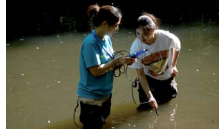
Bu öğrenciler su içinde çözülmüş oksijenin konsantrasyonunu ölçmek için oksimetre kullanıyorlar.
